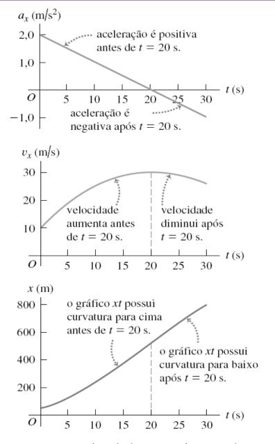
**Figura 2.29** A posição, a velocidade e a aceleração do carro do Exemplo 2.9 em função do tempo. Você é capaz de mostrar que, se esse movimento continuasse, o carro pararia no instante t = 44,5 s?
