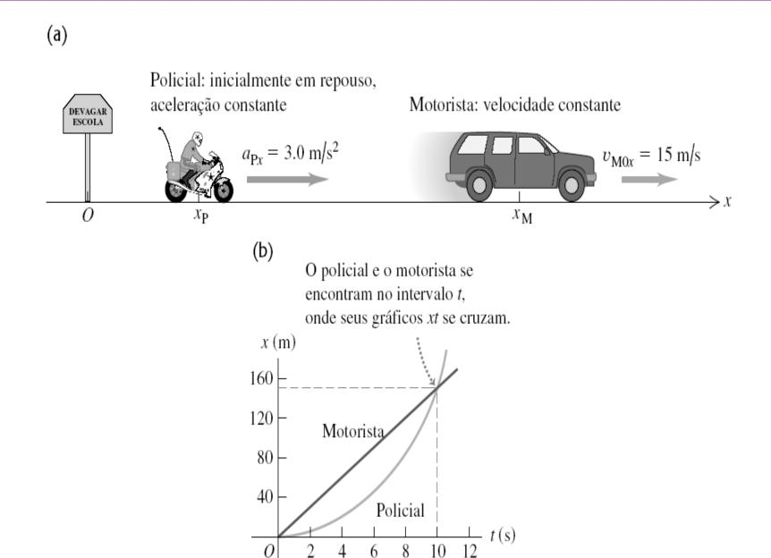
**Figura 2.21** (a) Movimento com aceleração constante concomitante a um movimento com velocidade constante. (b) Gráfico de *x* em função de *t* para cada veículo.
