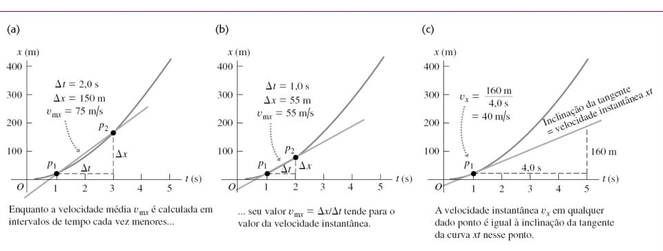
**Figura 2.7** Usamos um gráfico xt para ir de (a) e (b), velocidade média, para (c), velocidade instantânea  $v_x$ . Em (c) achamos a inclinação da tangente para a curva xt, dividindo qualquer intervalo vertical (em unidades de distância) ao longo da tangente pelo intervalo horizontal correspondente (em unidades de tempo).
