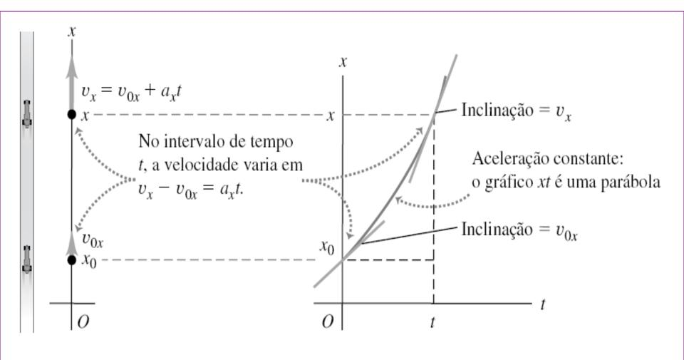
**Figura 2.18** a) Movimento em linha reta com aceleração constante. b) Gráfico de posição *versus* tempo (xt) para esse movimento (o mesmo que o mostrado nas figuras 2.15, 2.16 e 2.17). Para esse movimento, a posição inicial  $x_0$ , a velocidade inicial  $v_{0x}$  e a aceleração  $a_x$  são todas positivas.
