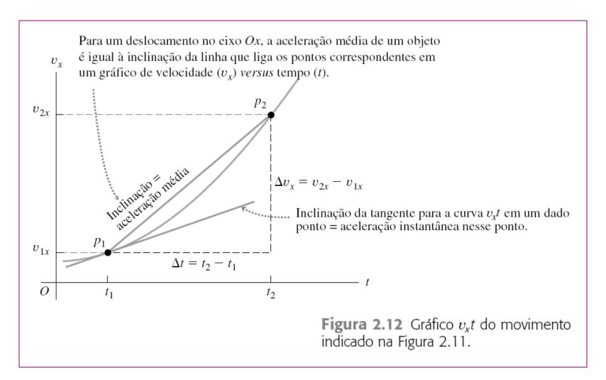
(a) Gráfico  $v_x t$  para o deslocamento de um objeto pelo eixo Ox
