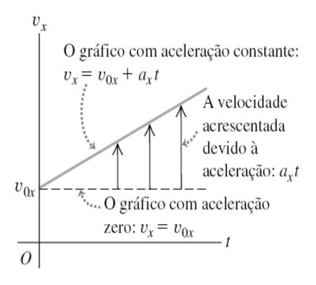
**Figura 2.19** como uma aceleração constante afeta a) o gráfico xt e b) o gráfico  $v_xt$  de um corpo.
