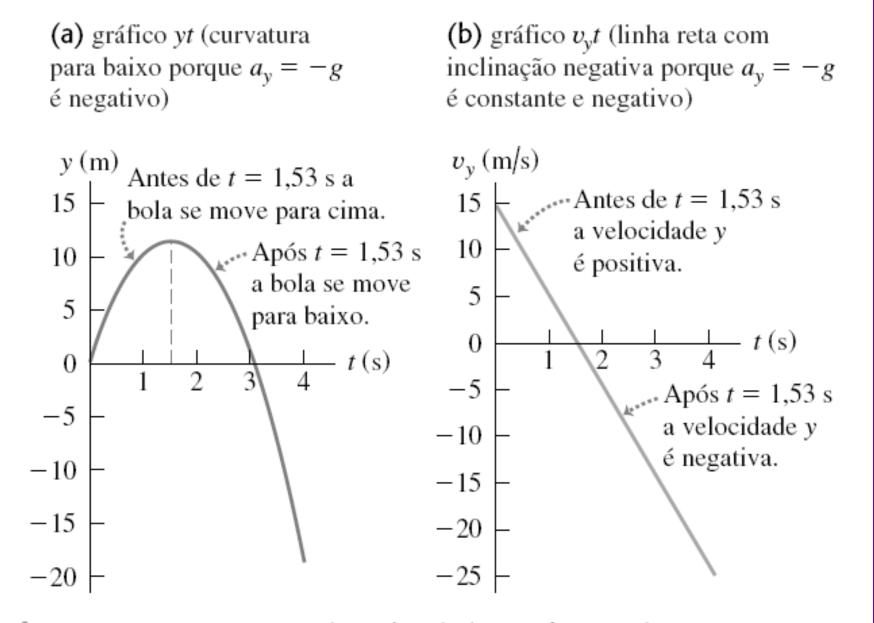
**Figura 2.25** a) Posição e b) velocidade em função do tempo para uma bola lançada verticalmente de baixo para cima com velocidade inicial de 15 m/s.
