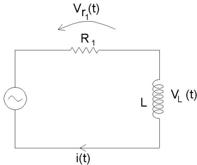
**Figura 1.13: Circuito para o estudo do comportamento de um indutor.**
