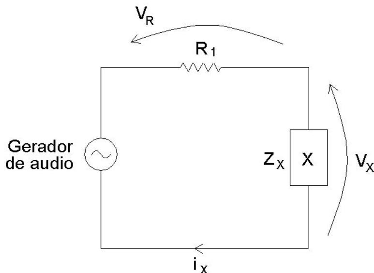
**Figura 1.2: Circuito para o estudo do elemento X.**
