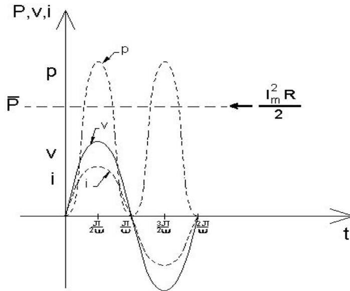
**Figura 1.9: Comportamento da potência instantânea e da potência média dissipada num resistor.**
