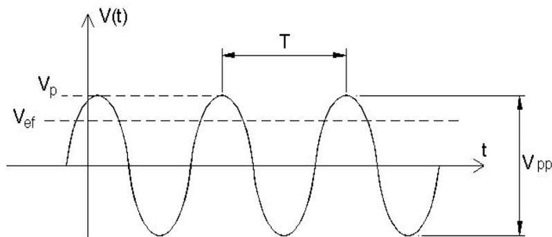
Figura 1.1: Tensão alternada senoidal em função do tempo.
