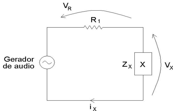
Figura 1.2: Circuito para estudo do elemento X.
