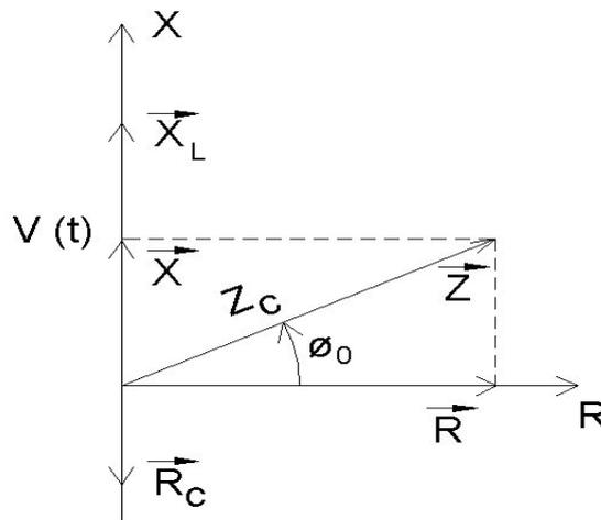
**Figura 1.7: Diagrama de fasores representando impedâncias em série.**
