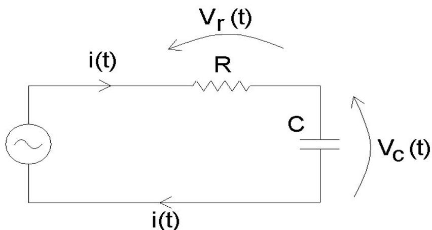
**Figura 1.10: Circuito para o estudo do comportamento do capacitor.**
