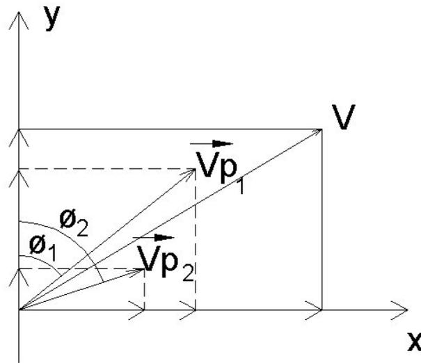
**Figura 1.6: Diagrama de fasores para soma de tensões alternadas (equação 1.33).**
