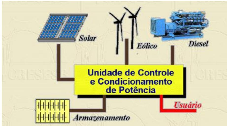
**Figura 26 – Sistema autônomo híbrido**
