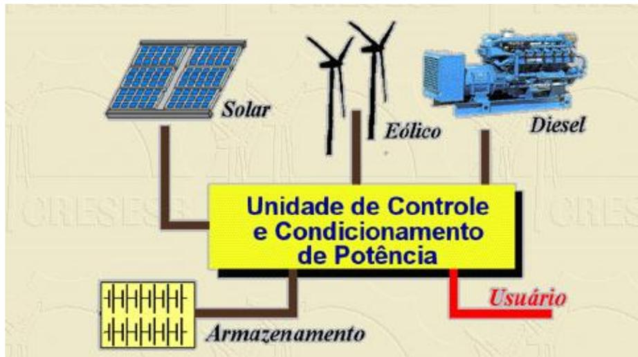
**Figura 26 – Sistema autônomo híbrido**
