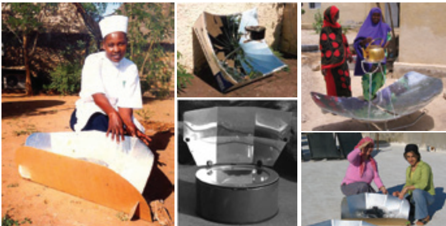
FIGURA 1.15. Cinco modelos de fogões solares para aquecimento e preparo de alimentos.
